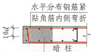
端部有暗柱时剪力墙水平分布钢筋端部做法
