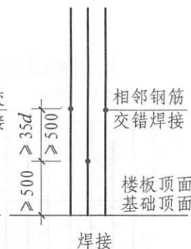
剪力墙边缘构件纵向钢筋连接构造
