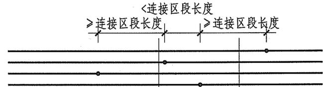
连接区段长度：机械连接为 $35d$
