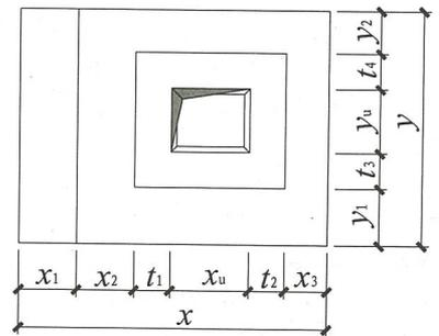
图 2.3.3-7 阶形截面杯口独立基础原位标注 (二)
