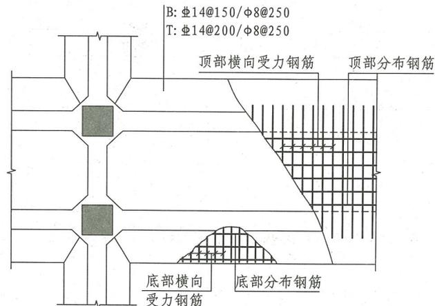
图 3.5.2-4 双梁条形基础底板配筋示意
