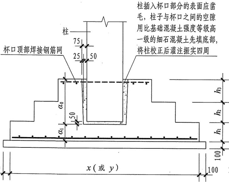
杯口独立基础构造
