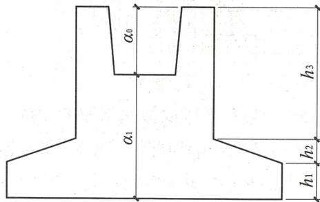
图 2.3.2-9 坡形截面高杯口独立基础竖向尺寸
