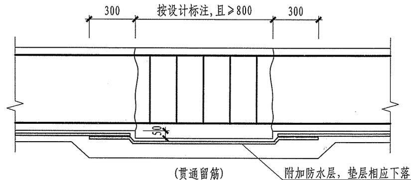
基础梁后浇带HJD构造
