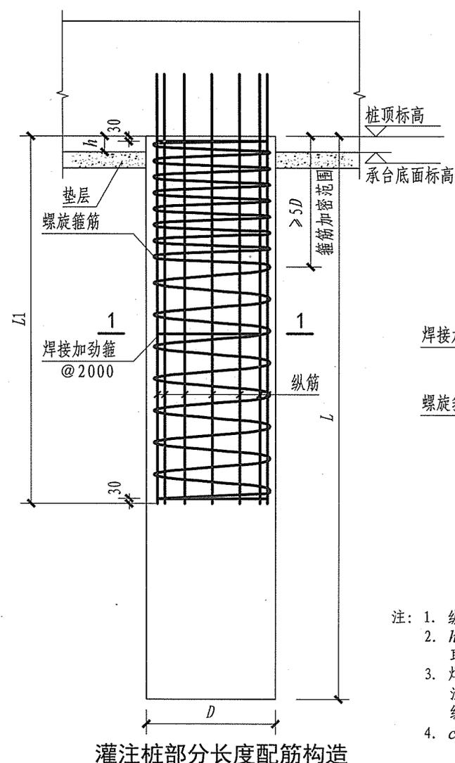
灌注桩部分长度配筋构造
