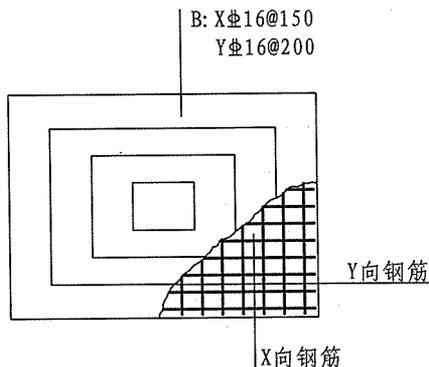
图 2.3.2-10 独立基础底板底部双向配筋示意
