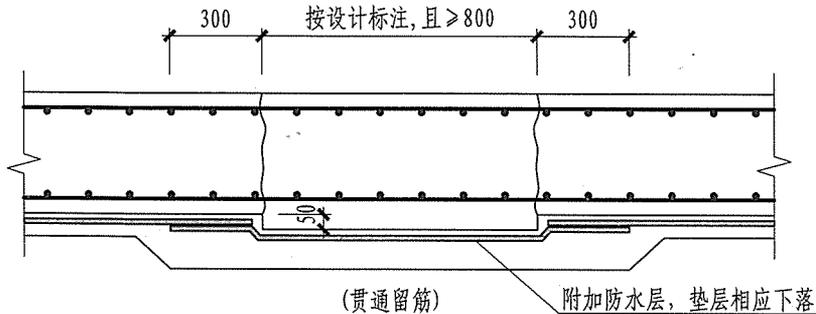
基础底板后浇带HJD构造
