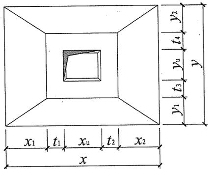
图 2.3.3-8 坡形截面杯口独立基础原位标注 (一)
