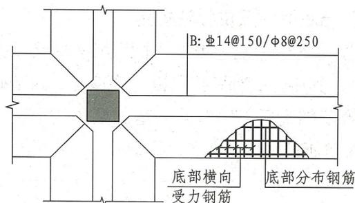
图 3.5.2-3 条形基础底板底部配筋示意
