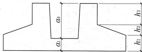
图 2.3.2-8 坡形截面杯口独立基础竖向尺寸
