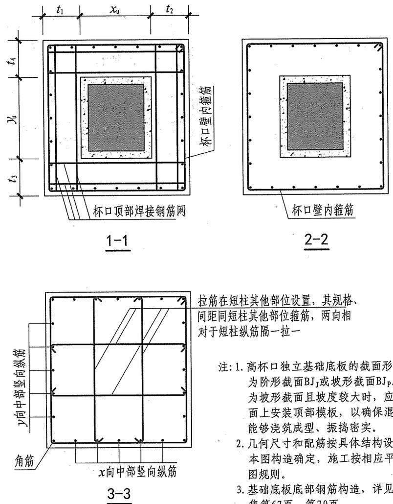
拉筋在短柱其他部位设置，其规格、间距同短柱其他部位箍筋，两向相对于短柱纵筋隔一拉一
