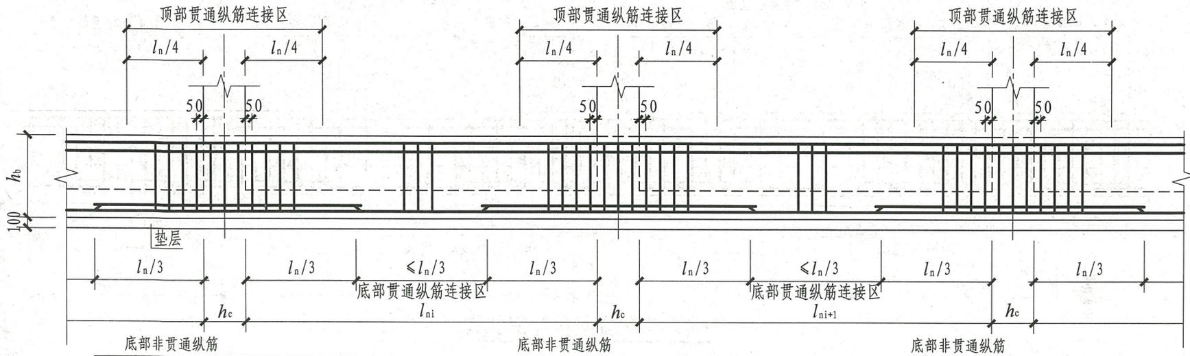
底部贯通纵筋在其连接区内采用搭接、机械连接或焊接。同一连接区段内接头面积百分率不宜大于50%。当钢筋长度可穿过一连接区到下一连接区并满足连接要求时，宜穿越设置
