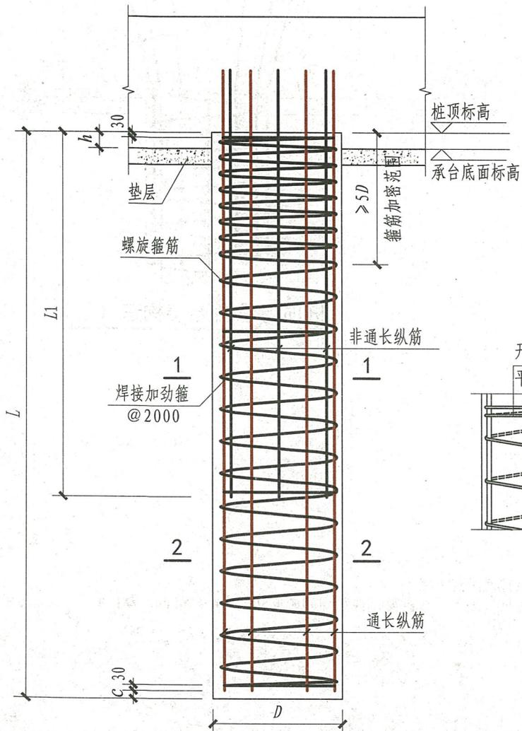
灌注桩通长变截面配筋构造
