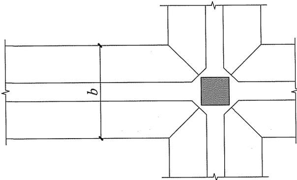
图 3.5.3 条形基础底板平面尺寸原位标注
