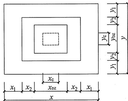
图 2.3.3-3 带短柱独立基础的原位标注
