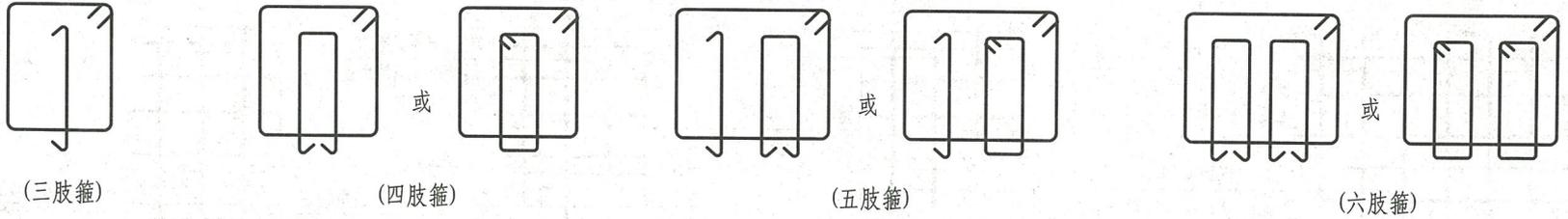
**基础梁箍筋复合方式**
