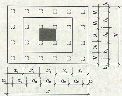
图 6.6.3-1 矩形独立承台平面原位标注
