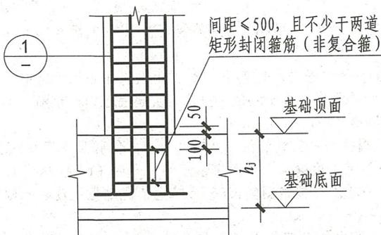
(c) 保护层厚度  $> 5d$ ; 基础高度不满足直锚
