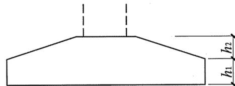
图 2.3.2-3 坡形截面普通独立基础竖向尺寸
