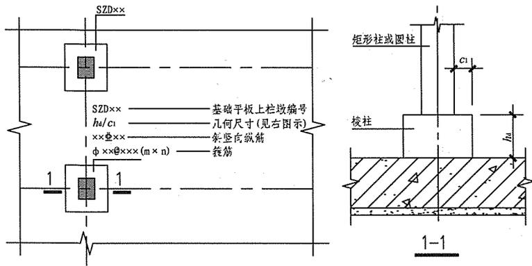
图 7.2.3-2 棱柱形上柱墩引注图示
