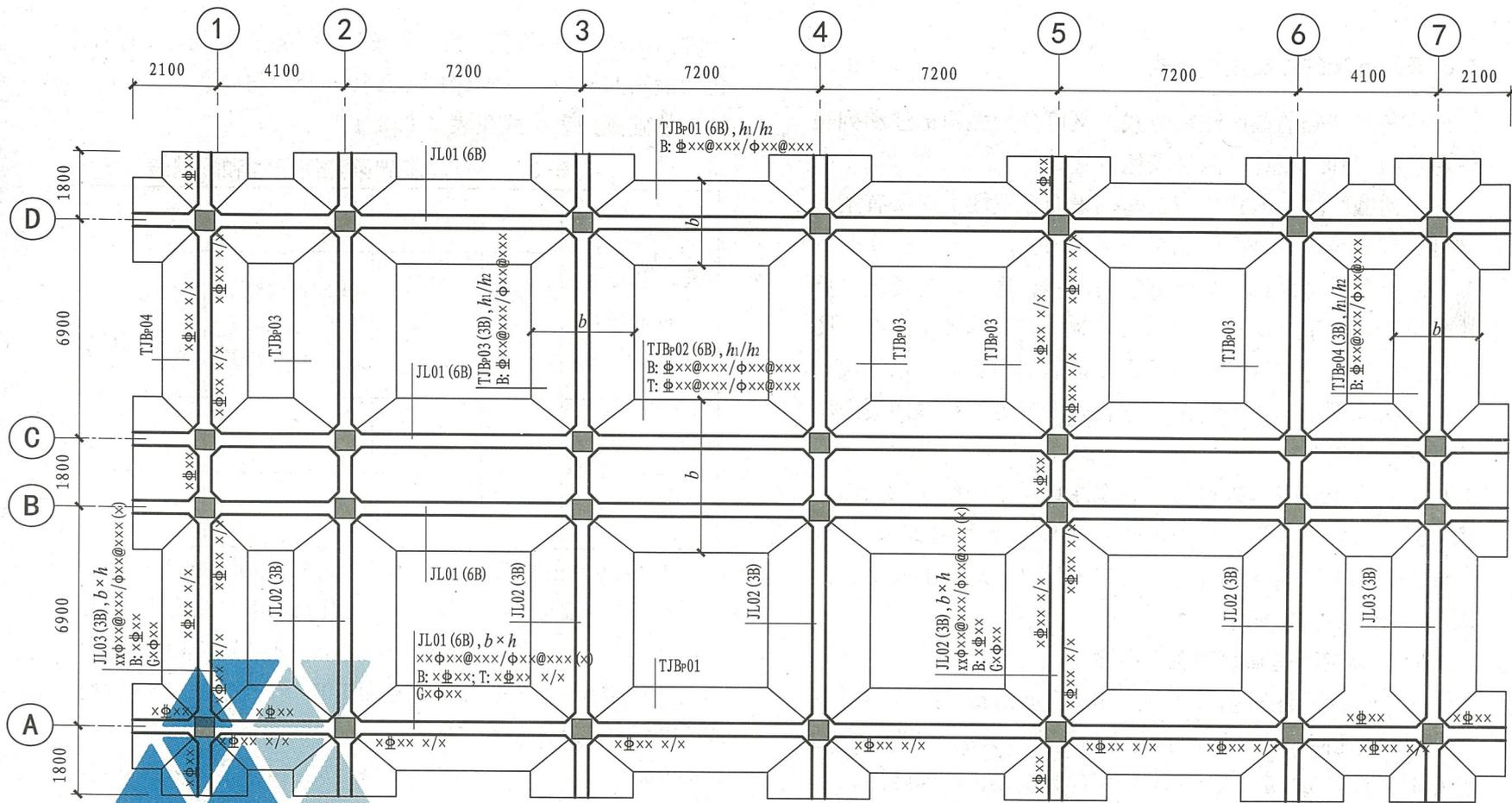
条形基础平法施工图平面注写方式示例
