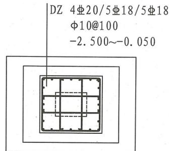
图 2.3.2-15 独立基础短柱配筋示意
