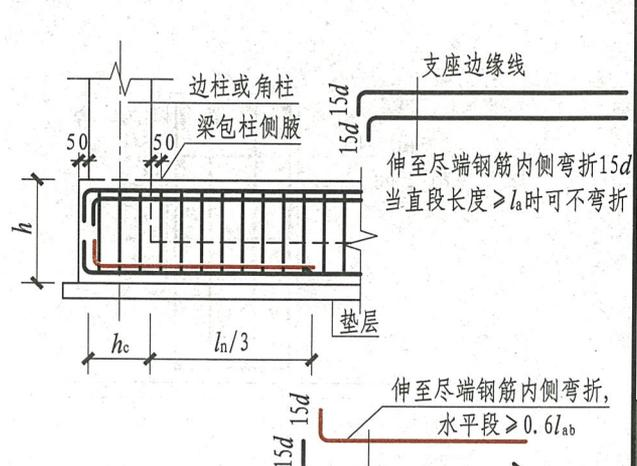
梁板式筏形基础梁端部无外伸构造
