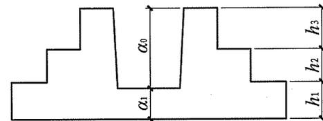
图 2.3.2-4 阶形截面杯口独立基础竖向尺寸（一）
