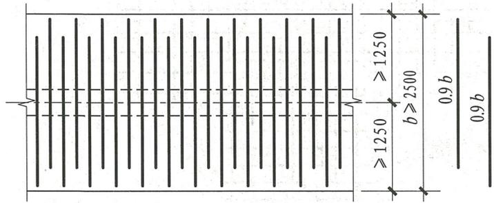
**条形基础底板配筋长度减短10%构造**
