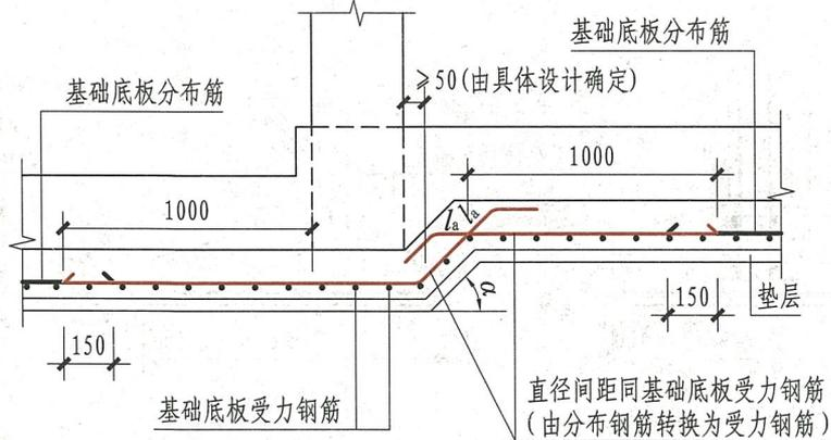
**柱下条形基础底板板底不平构造**
