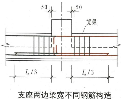
支座两边梁宽不同钢筋构造
