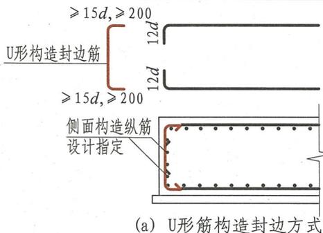
(a) U形筋构造封边方式
