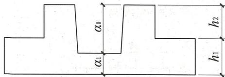
图 2.3.2-5 阶形截面杯口独立基础竖向尺寸 (二)
