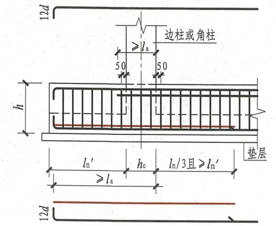
梁板式筏形基础梁端部等截面外伸构造
