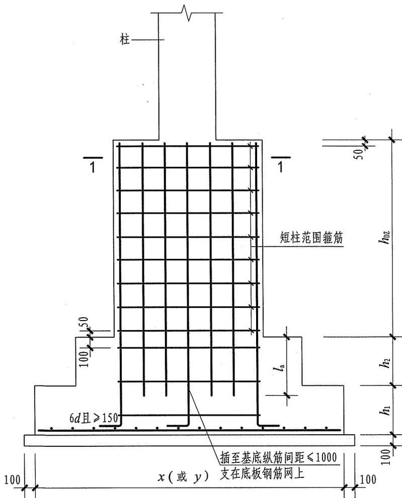
单柱带短柱独立基础配筋构造
