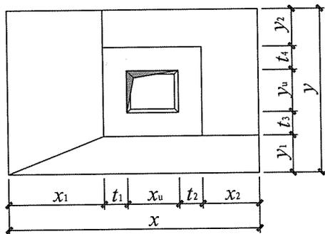
图 2.3.3-9 坡形截面杯口独立基础原位标注 (二)
