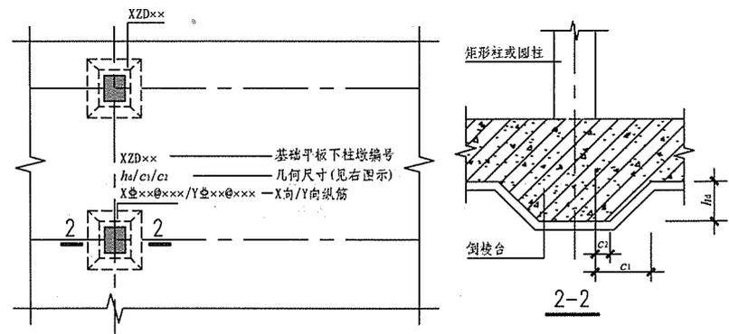
图 7.2.4-1 棱台形下柱墩引注图示
