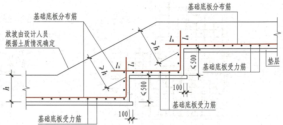
**墙下条形基础底板板底不平构造 (一)**
