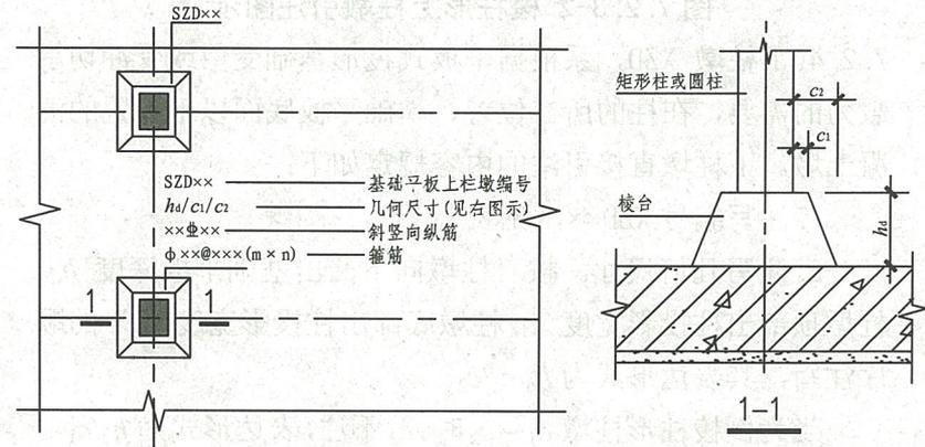
图 7.2.3-1 棱台形上柱墩引注图示
