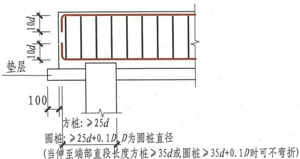
承台梁端部钢筋构造
