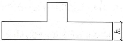
图 3.5.2-2 条形基础底板阶形截面竖向尺寸
