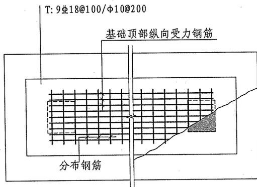
图 2.3.6-1 双柱独立基础顶部配筋示意
