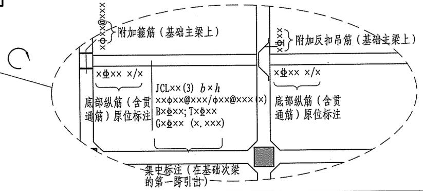
基础主梁JL与基础次梁JCL标注图示 图集号 16G101-3
