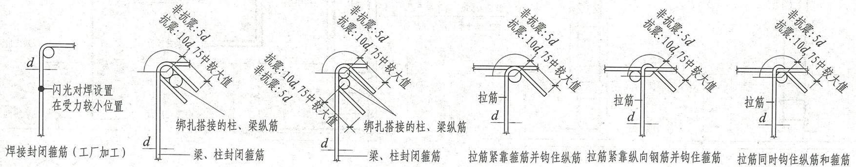
**封闭箍筋及拉筋弯钩构造**
