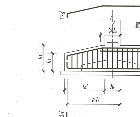
条形基础梁端部变截面外伸构造
