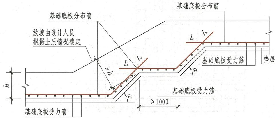
**墙下条形基础底板板底不平构造 (二)**
