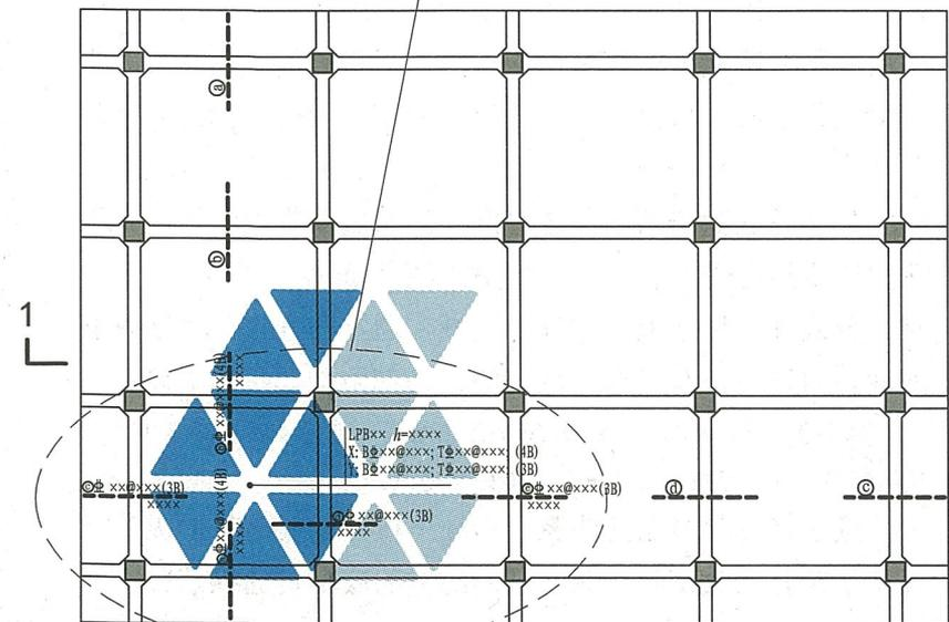
梁板式筏形基础平板LPB标注图示
