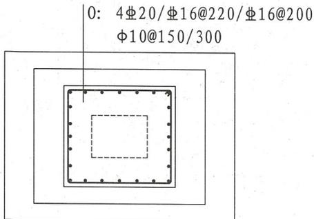
图 2.3.2-13 高杯口独立基础短柱配筋示意
