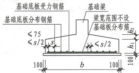
(d) 条形基础无交接底板端部构造
