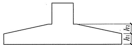
图 3.5.2-1 条形基础底板坡形截面竖向尺寸
