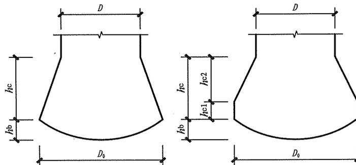
图 6.2.2 扩底灌注桩扩底端示意
