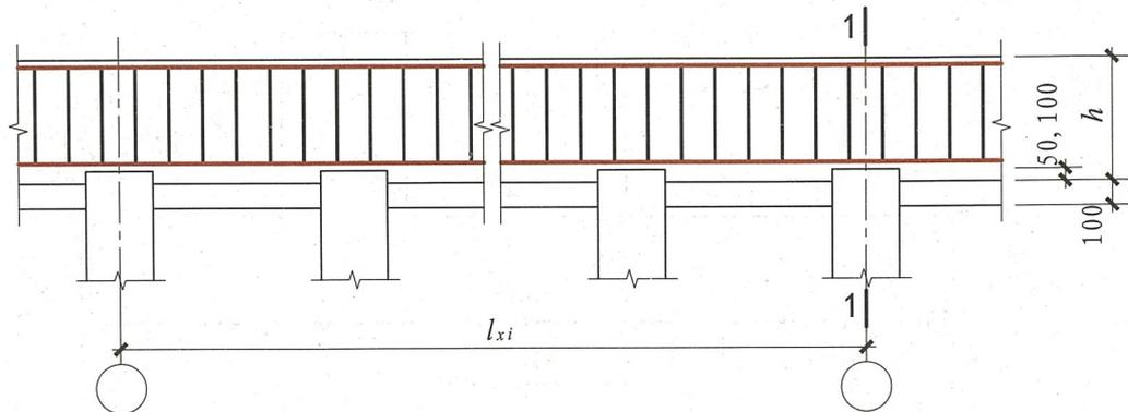
墙下单排桩承台梁GTL钢筋构造
