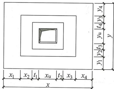
图 2.3.3-6 阶形截面杯口独立基础原位标注 (一)
