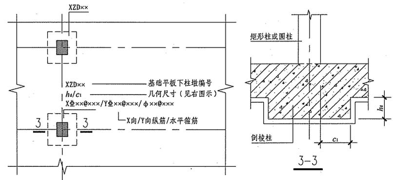
图 7.2.4-2 棱柱形下柱墩引注图示
