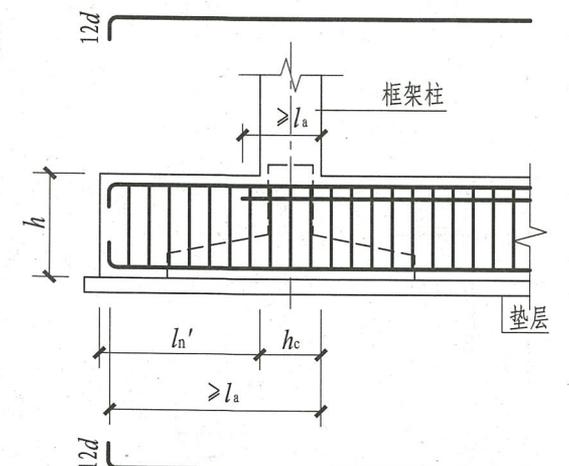
条形基础梁端部等截面外伸构造
